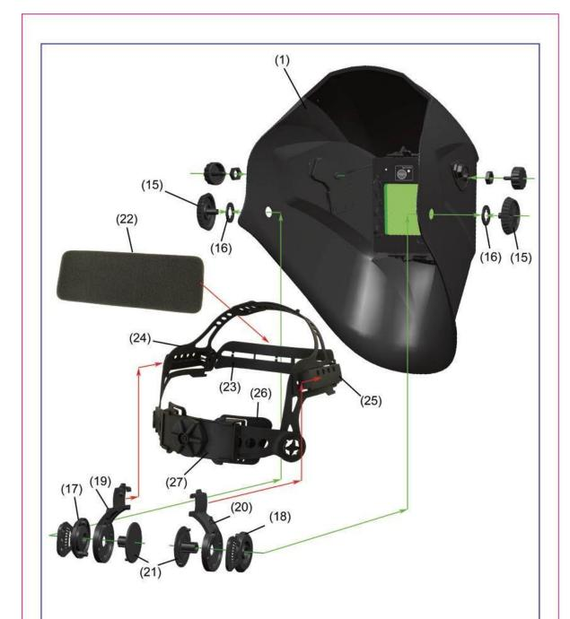
1. Каркас маски 15. Болт фиксации 16. Контровочная шайба 17. Регулятор угла наклона маски (левый) 18. Регулятор угла наклона маски (правый) 19. Реечный регулятор размера (левый) 20 Реечный регулятор размера (правый) 21. Фиксирующий зажим 22. Повязка головная (тканевая) 23. Фронтальная сторона фиксатора размера 24. Левая сторона фиксатора размера 25. Правая сторона фиксатора размера 26. Задняя эластичная подушка 27. Устройство регулятора размера (стягивание-ослабление)
